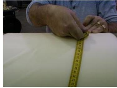
Figure 4: Medição incorreta porque a fita não está paralela à borda da bobina.
